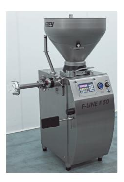
F-LINE F50 standard est équipé d'une **trémie divisible de 90 litres**. Le remplissage et le nettoyage intermédiaire deviennent plus simple.
