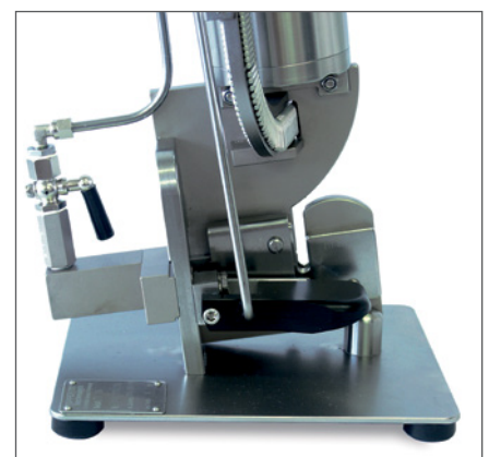
Actionnement à levier palpeur et couteau de sectionnement blocable.
