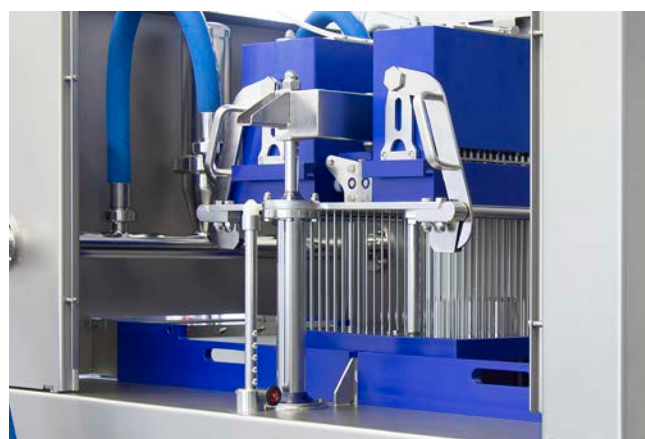
Tête injection et attendrissement (à droite) avec amortissement, aiguilles d'injection (2 mm, 3 mm ou 4 mm de diamètre), couteaux attendrisseurs à pointe aiguisée (4 mm de diamètre)
