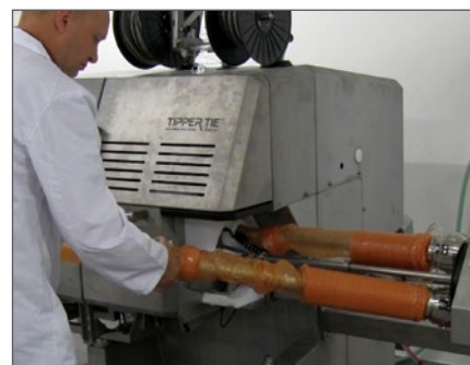
La tourelle rotative en option permet des changements de boyaux pratiquement sans temps d'arrêt
