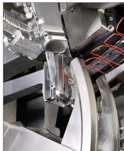
Technique du shuttle-clip : refouler et clipper – ultra précis, rapide, garantit des calibres constants et ménage les boyaux.
