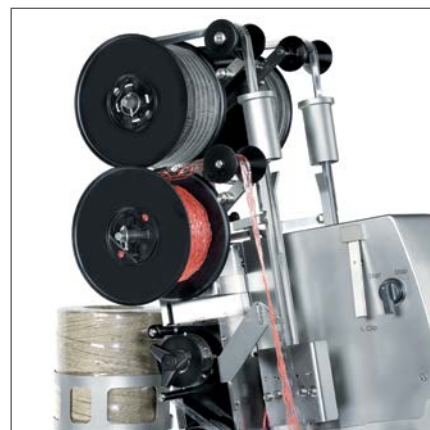
Bobines de clips, boucles et distributeur de ficelle pour garantir une production efficace.
