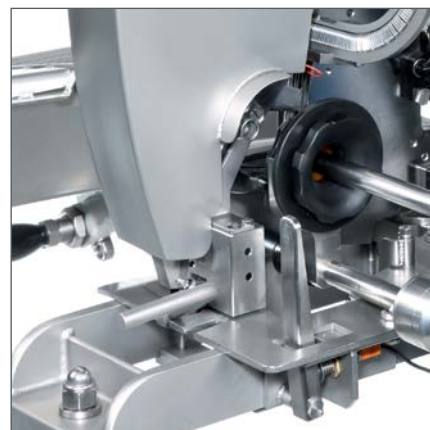
Commande par levier palpeur pour garantir des portions de taille identique.
